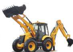
Lonking 84C 8,9 т, WEICHAI WP46100E220 74кВт; КПП Carraro, мосты Carraro; Аксиально-поршневой насос, гидравлика Bosch Rexroth
