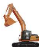
Экскаватор PB400 Экспл. масса 39,3 т Ковш скальный 1,9 м³ Дв. Isuzu 6HK1/DEC Cummins 6L8.9-C325(Tier 2) Ном. мощность 212/241 кВт
