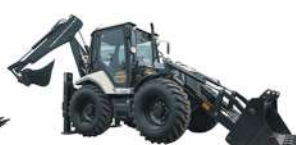
Çukurova 888XG 8,9 т, Perkins 74,5 кВт, 4WD, Крабовый ход
