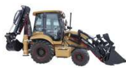
PB388T 8,9 т, Cummins; 4BTA3.9-C100; 74кВт; Мосты и КПП Synchro Shuttle, пр-ва Carraro; Аксиально-поршневой насос Henni; SRS; 4WD
