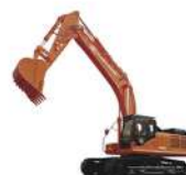
Экскаватор PB500 Экспл. масса 50,5 т Ковш скальный 2,6 м³ Дв. Isuzu 6WG1-XDHA03-03-C3 Ном. мощность 300 кВт
