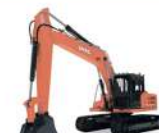
Гусеничные экскаваторы E225C: 23 т, ЯМЗ-536, 147 кВт, 1,0 м³ E225NC: 22,7 т, ЯМЗ-536, 147 кВт, 0,9 м³ E248C: 23,7 т, ЯМЗ 536, 147 кВт, 1,2 м³ E 330C 33 т, ЯМЗ-536, 190 кВт, 1,6 м³
