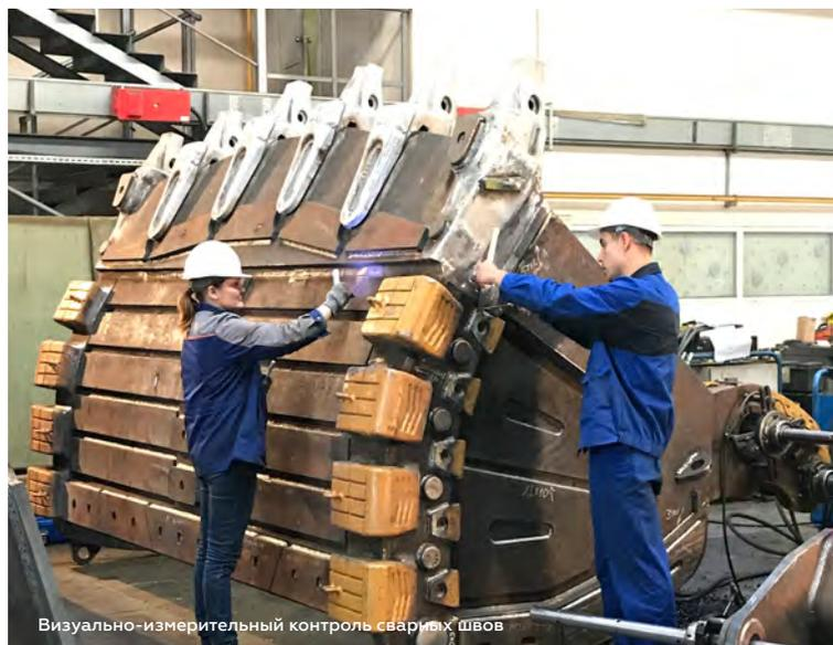
Визуально-измерительный контроль сварных швов
