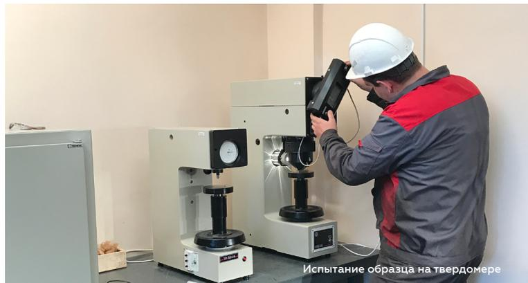
Испытание образца на твердомере
