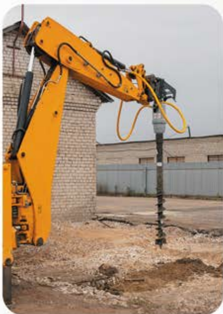
PROFBREAKER SHB с планетарным редуктором
